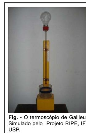
Fig. - O termoscópio de Galileu. Simulado pelo Projeto RIPE, IF/USP.
